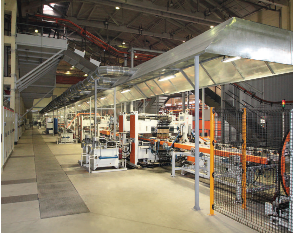
Новая современная автоматизированная линия сварки радиаторов «PRADO»
