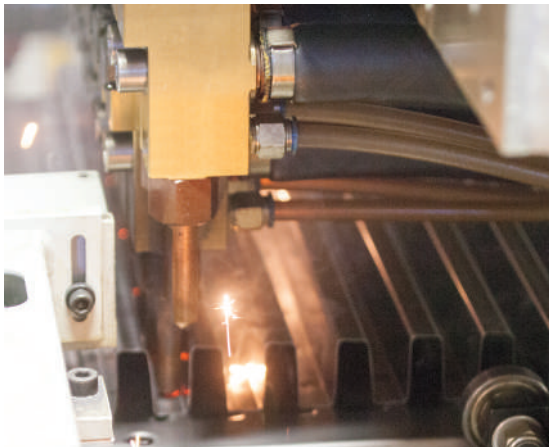
Сварка конвекционного листа с панелью радиатора
