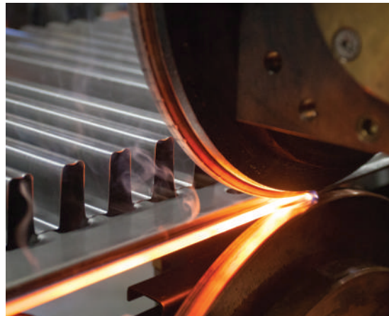
Сварка продольных швов панелей радиатора
